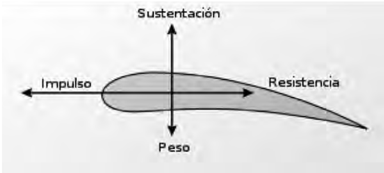
Perfil aerodinámico del ala.
