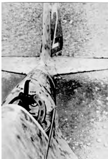
Puesto posterior del ametrallador con la cúpula eliminada (Foto AHEA).
