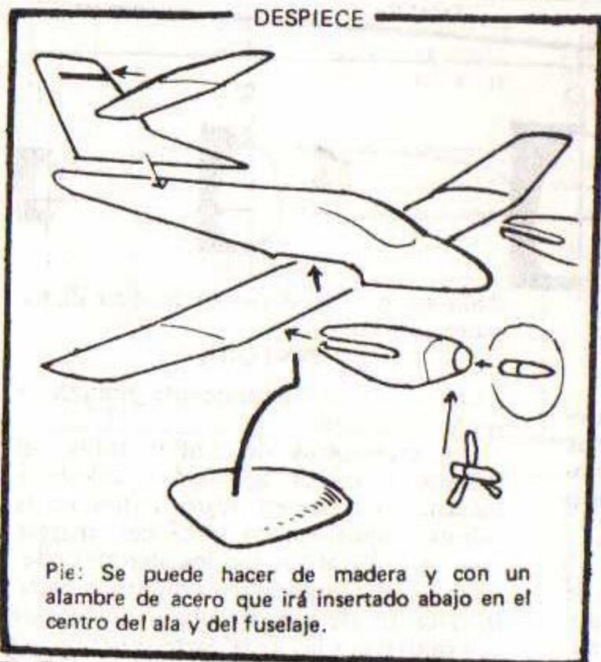
Pie: Se puede hacer de madera y con un alambre de acero que irá insertado abajo en el centro del ala y del fuselaje.
