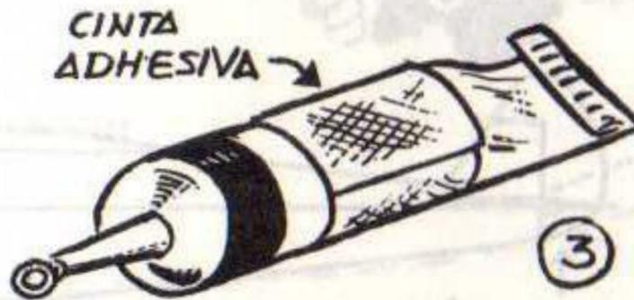
CUANDO EL POMO TENGA UNA PÉRDIDA, DEJAR SECAR EL CEMENTO SOBRE LA ROTURA Y LUEGO ENVOLVER CON CINTA ADHESIVA.
