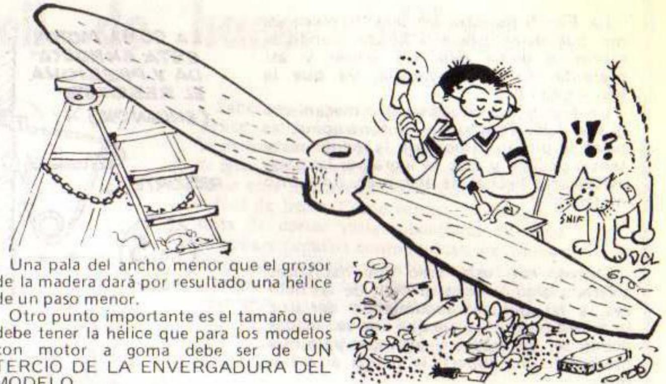
Una pala del ancho menor que el grosor de la madera dará por resultado una hélice de un paso menor.
